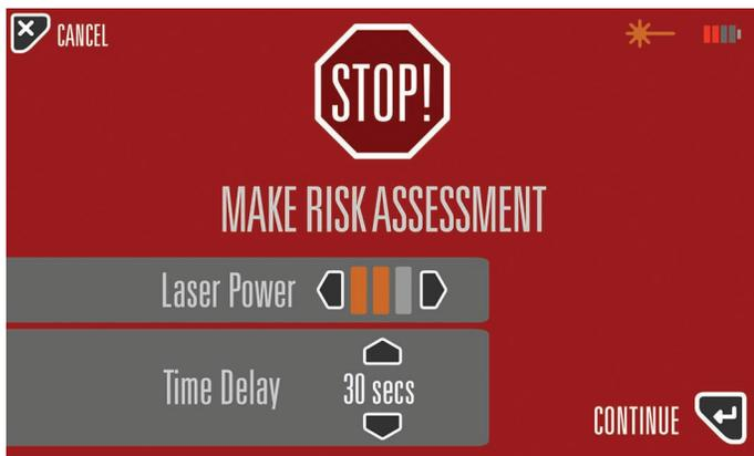
그림 2. 장비를 안전하게 사용하기 위해 Time Delay 또는 레이저 출력을 설정하는 화면이 제공됩니다.
